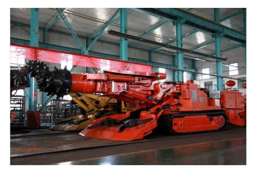
掘锚机操作: 1. 掘进割煤和进行支护作业时,要密切注意顶板和煤帮情况。如有不安全因素,应立即撤出人员和设备,经处理后方可恢复生产。2. 停止割煤时,要立即关闭水阀。3. 严禁带电维修、保养,所有悬空部位必须支撑。4. 掘锚司机使用遥控器操作时,司机必须在安全位置。5. 停机前必须挖起锚机铲板,切割滚筒掉到地板上,输送机降到较低位置。6. 掘锚机配备3-4人操作,一人负责掘进,两人负责锚定,其他人员负责运送材料等。7. 严禁站在钻箱上。8. 树脂药筒对皮肤有刺激作用,司机必须穿长袖工作服,扎紧袖口,戴手套、口罩,并保护眼睛。9. 螺栓支撑操作前,必须将机身右侧的三个锁紧按钮拔出至支撑状态;切割或行走前,机身右侧的三个锁定按钮必须按到切割状态。
