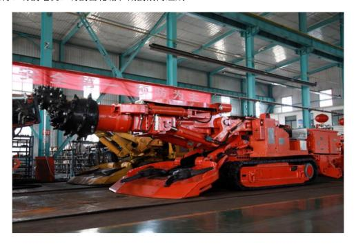
江苏佳煤机械有限公司掘锚机的设计采用掘进机相同的原理,制造的设备开机率高,性能好。江苏佳煤机械有限公司掘锚机的特点与其他设备不同:1。掘进和锚杆支护同时进行;2.大功率低速截割辊较大限度地减少了截割过程中产生的灰尘;3.装载输送装置可以相对于截割装置移动,达到较佳的装运效果;4.截割切头和截割操作采用电控,优化了截割电机的工作负荷和切割程序;5.低轨道对地面比率;6.截割压路机碾压后,液压支架及时支撑顶板,保护作业人员;7.利用液压缸推力切割,履带到位,不会损坏软底板;8.自动油脂润滑系统,减少维护工作量。9.截割压路机配备高压水冲刷系统;10.机载顶板和侧邦锚杆机;11.锚杆机的工作处于液压顶的安全保护之下;12.除了螺栓机,掘锚机是无线遥控.掘锚护一体机适用于矩形、梯形全煤巷道快速掘进,可同时满足单排或双排进尺施工模式。甘肃煤矿掘锚机价格
