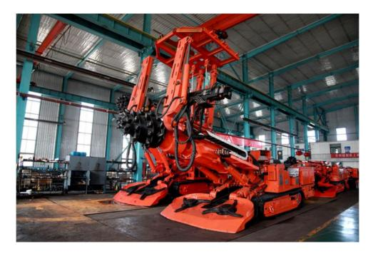
保护掘锚机截齿:掘锚机的截齿非常容易磨损。如果在生产过程中不及时更换截齿,会对齿座造成磨损,一旦齿座损坏,不仅很难更换截齿,影响正常生产,还会破坏掘锚机整个切割滚筒的应力平衡,从而缩短整套设备的使用寿命,给公司造成财产损失。如果说剔牙是一个人的"牙齿",那么齿座就是"牙龈"。如果牙齿坏了,可以更换。如果牙龈出了问题,就很难好。为此,技艺精湛的工匠们在从根本上解决问题、减少财产损失、改善进尺的基础上,制定了一系列保护"牙龈"的具体措施。首先,生产班每开挖一米必须停机检查截齿磨损程度,损坏及时更换;其次,掘锚机焊有防护"牙套",易磨损的齿座;周围焊有耐磨小钢板,对于一些磨损不严重的齿座,堆焊采用耐磨堆焊焊条。保护设备,节约成本,同时较大的降低员工的劳动强度。甘肃煤矿掘锚机价格掘锚一体机是集截割、装载、行走、除尘、锚杆支护于一身的综合化采煤掘进设备。
